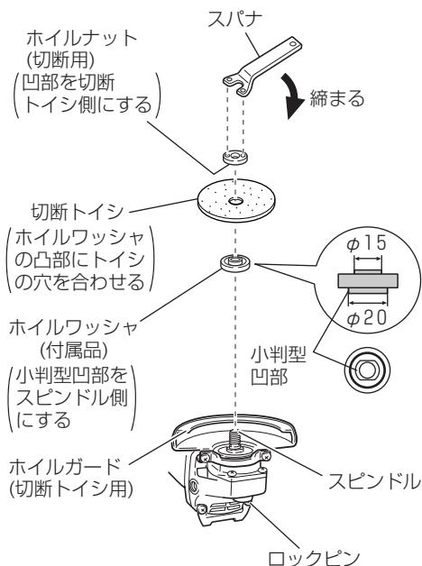
**注** •モーター故障の原因になるので、1回の切込み量は5mm以下にしてください。
