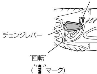
チェンジレバーを回すことにより "回転+打撃"、"回転" の2つのモードに切替えることができます。
