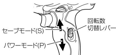
ハンドル部側面の回転数切替えレバーを下方にスライドするとパワーモード (P)、上方にスライドするとセーブモード (S) になります。作業に応じて切替えレバーを選択してください。
