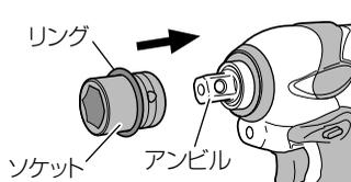
リングを溝からずらし、アンビルの穴とソケットの穴が合うようにしてソケットをさし込みます。
