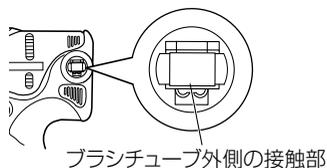
**注** カーボンブラシのツメは、必ずブラシチューブ外側の接触部に挿入してください（ツメは2カ所あるうちのどちらでも良い）。間違えるとカーボンブラシのツメが変形し、モーターの早期故障の原因になります。
