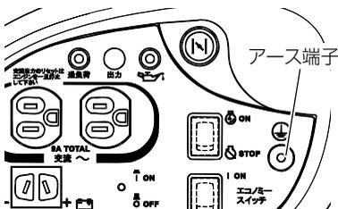
機体のアース端子にアース線を接続し、先端を地中に埋められた接地極にアースしてください。
