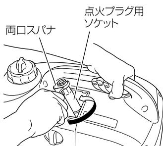
(3) 標準付属品の点火プラグ用ソケットと両口スパナを使用してスパークプラグをはずします。
