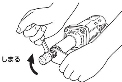
軸付トイシは外径 32 mm 以下、軸の長さは 30 mm のものをご使用ください。
