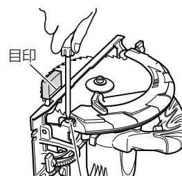
4 目印を付けた木片をベース前方側に移動し、平行度調整ねじをプラスドライバーで回して目印がベース側面に合うようにします。
