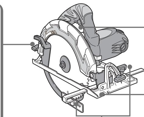
**注** 切断を始める前に、ベース面とのこ刃が直角になっている事を確認してください。(P.12 直角度の微調整参照)
