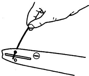
ガイドバーの溝や油の出る穴に切粉などがつまると、油がまわらなくなり故障の原因になります。ときどきガイドバーをはずし、針金などで掃除してください。
