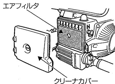
長期間使用しエアクリーナーに木くずなどがたまるとエンジン性能の低下の原因になるので、ときどき点検してください。
