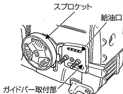
ガイドバーをはずして、ガイドバー取付部、スプロケットのまわりや給油口に付いている切粉を掃除してください。
