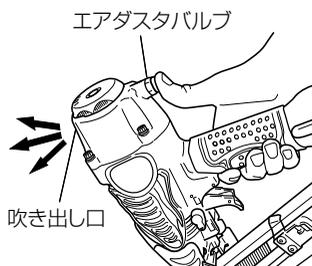
この機体は、作業中に発生する木くずなどを吹きとばすためのエアダスタを備えています。
