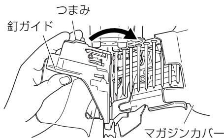
○ マガジンカバーが閉じられていることを確認した後、釘ガイドとつまみに指をかけ、つまみを下へ押しながら、釘ガイドを右に回して完全に閉じます。
