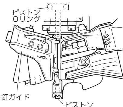
ピストンローリングは、消耗品です。射出口を下方に向け、釘ガイドを開けたときに、ピストンが下降しているときは、ピストンローリングの交換時期です。交換はお買い求めの販売店または日立工機電動工具センターに依頼してください。
