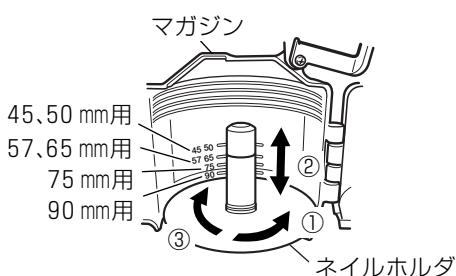
調整は、①ネイルホルダを約90°左に回します。②ネイルホルダを上下に動かし、使用する釘の長さに合わせてマガジンの目印の位置にネイルホルダの上面を合わせます。
