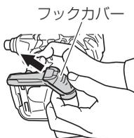
**3** 乾電池を交換し、フックカバーを取付ける
