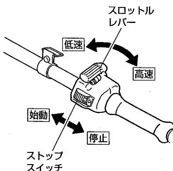
スロットルレバーを**低速**の位置に戻して、しばらく運転します。次にストップスイッチを**停止**の位置にします。
