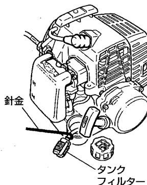
タンクフィルターがつまるとガソリンが上らず、エンジンの回転不調の原因になりますので、ときどき点検してください。
