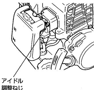
スロットルレバーを低速の位置にしてアイドル調整ねじをしめ込むと低速回転（アイドリング回転）が高くなり、ゆるめると低くなります。スロットルレバーを低速の位置にしても刈刃が回転するときは、刈刃が回転しないようなアイドリング回転に調整してください。
