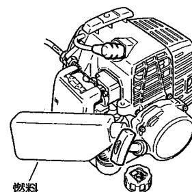
始動前のエンジンが冷えた状態で、燃料 [ガソリン25：オイル（2サイクル専用オイル）1】を燃料タンクに入れます。
