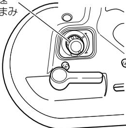
帯のこ周速の設定は、帯のこ周速設定用つまみをまわし、材料の材質に合わせ設定します。
