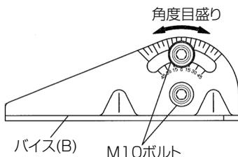
この機体は左右 45 度までの角度切断ができます。付属の六角棒スパナで M10 ボルト (2 本) をゆるめ、角度目盛りとベースの刻印を目安にバイス (B) の角度を設定してください。
