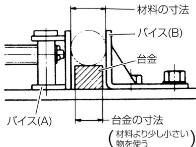
トイシの外径が小さくなった場合は、左図のように、材料の寸法より少し小さめの台金をバイス (A) と (B) の間に入れて使用すると経済的にトイシを使うことができます。
