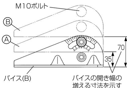
M10 ボルトをゆるめ、バイス (B) を後方に移動すると、バイスの開き幅 (バイス (A)、(B) の材料接触面の最大距離) を 2 段階に広げることができます。
