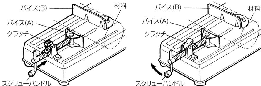
この機体のバイス (A) は、クラッチを解除する (上左図) と早送りでき、セット (上右図) するとねじ送りができます。早送りとねじ送りを使い分けることにより効率良く作業できます。
