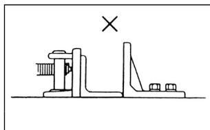
材料がアングル鋼、チャンネル鋼の場合は、必ず上図のように固定してください。
