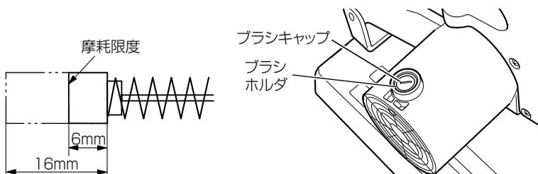
モーター部(8ページの図参照)には、消耗品であるカーボンブラシを使用しております。カーボンブラシの摩耗が大きくなりますと、モーターの故障の原因となりますので、長さが摩耗限度(6mmぐらい)になりましたら新品と交換してください。
