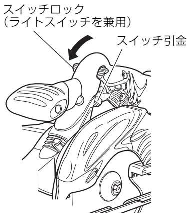
(1) この工具本体には不用意にモーターが起動しないように、ハンドル側面に「スイッチロック」が付いております。「スイッチロック」を左図に示す矢印側に押した状態でスイッチ引金を引くとモーターが起動します。
