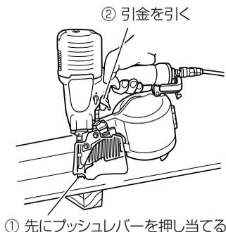
単発打ちは、仕上げを重視する場合や狙った所に釘を打つ場合に使用します。打ち込む所にプッシュレバーを押し当て、引金を引く動作で、釘を一本ずつ打つことができます。
