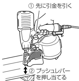
連続打ちは、はじめに引金を引いておき、その後、釘を打つ所にプッシュレバーを「トン・トン・トン」と押し当てれば、連続的に作業ができます。
