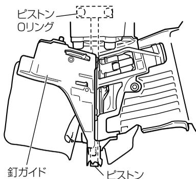
ピストンリングは、消耗品です。射出口を下方に向け、釘ガイドを開けたときに、ピストンが下降しているときは、ピストンリングの交換時期です。交換はお買い求めの販売店に依頼してください。
