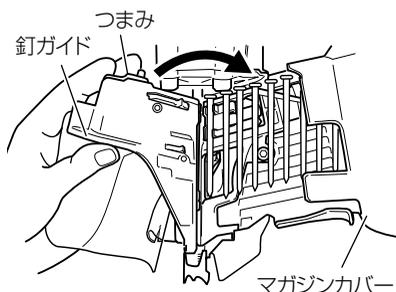
○マガジンカバーが閉じられていることを確認した後、釘ガイドとつまみに指を掛け、つまみを下へ押しながら、釘ガイドを右に回して完全に閉じます。
