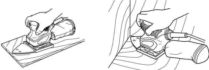
ハウジング上部を握り、サンドペーパーが加工面に一様に当たるよう機体を加工面に軽く押しつけます。必要以上に強く押しつけると、モーターに無理がかかり、サンドペーパーの寿命を短くするだけで、研磨能率を悪くします。
