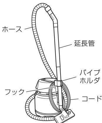
掃除の途中にちょっと中断したいときに、フックに延長管のパイプホルダを引掛けることができます。そのまま保管できます。コードも束ねて引掛けることができます。
