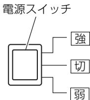
「強」側を押すと機体が強運転、「弱」側を押すと弱運転します。
