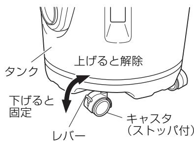
キャスター(ストップ付)のレバーを下げるとき車輪の回転が固定されます。車輪の固定を解除する場合は、レバーを上げます。
