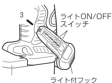
(1) フックの位置を図中3の位置に合わせます。照射位置が合わない場合は、取付け位置を調整してください。
