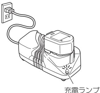
3. 充電器のさし込みプラグを電源コンセントにさし込みます。充電ランプが点灯し、充電を開始します。
