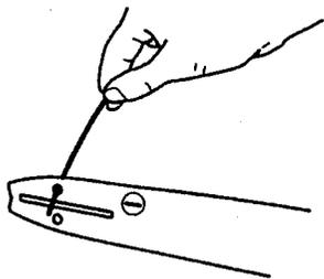
ガイドバーの溝や油の出る穴に切粉などが詰まると、油がまわらなくなり故障の原因になります。ときどきガイドバーをはずし、針金などで掃除してください。
