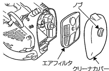
長期間使用しエアクリーナに木くずなどがたまるとエンジン性能の低下の原因になるので、ときどき点検してください。
