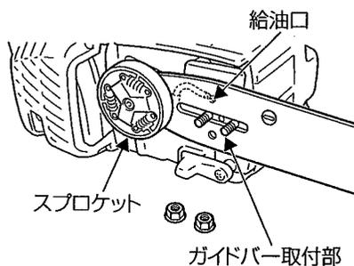
ガイドバーをはずして、ガイドバー取付部、スプロケットのまわりや給油口に付いている切粉を掃除してください。
