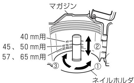
調整は、①ネイルホルダを約 90° 左に回します。②ネイルホルダを上下に動かし、使用する釘の長さに合わせてマガジンの目印の位置にネイルホルダの上面を合わせます。
