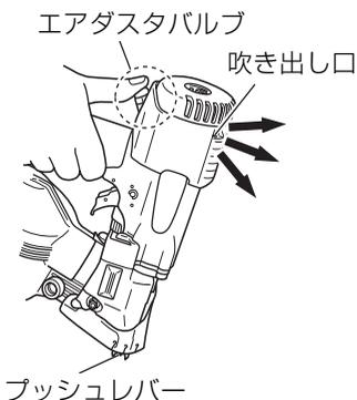
この機体は、作業中に発生する木くずなどを吹きとばすためのエアダスタを備えています。
