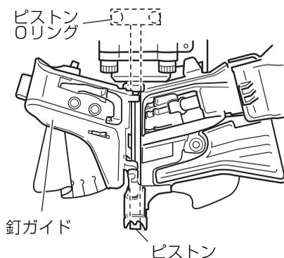
ピストンリングは、消耗品です。射出口を下方に向け、釘ガイドを開けたときに、ピストンが下降しているときは、ピストンリングの交換時期です。交換はお買い求めの販売店または日立工機電動工具センターに依頼してください。
