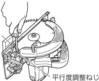
ベース側面とこの刃の平行度を平行度調整ねじで微調整できます。
