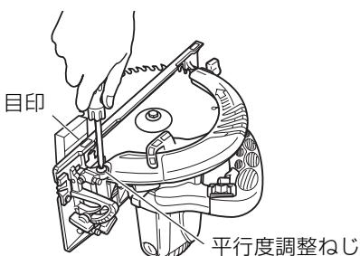
ベース側面とのこ刃の平行度を平行度調整ねじで微調整できます。
