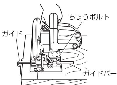
(1) 前後のガイドバーをベース側面の穴に通します。ロングガイドを左右に動かして切断位置を調整します。
