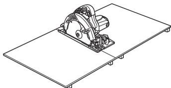
材料の切り落とし側が大きいときは、切断中に材料の重みでのこ刃がはさみつけられないように切り落とし側にも安定性のよい台、または角材を設けてください。
