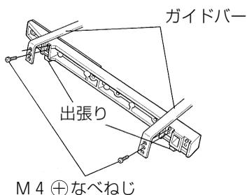
ガイドバーをベース側面の穴に通します。ガイドを左右に動かして切断位置を調整します。
