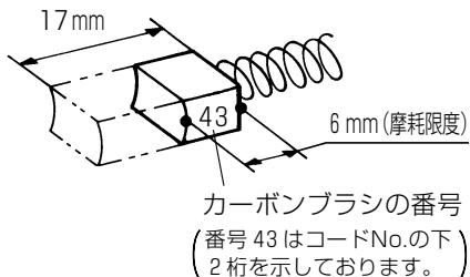
モーター部には、消耗品であるカーボンブラシを使用しております。カーボンブラシの摩耗が大きくなりますと、モーターの故障の原因となりますので、長さが摩耗限度(6 mm)ぐらいになりましたら新品と交換してください。
