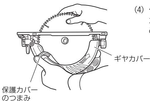
(4) 保護カバーのつまみをもって、保護カバーをギヤカバーの中に引き込め、のこ刃を取り出します。
