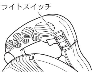
ライトはスイッチの「ON」側を押すと点灯し、「OFF」側を押すと消灯します。
