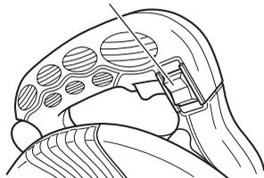
ライトはスイッチの「ON」側を押すと点灯し、「OFF」側を押すと消灯します。
