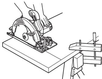
切断する材料の切り残り側は、しっかり押さえておくようにしてください。
