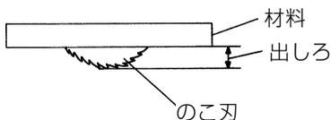
のこ刃は材料の下面より出ますので、材料は作業台の上に乗せて切断してください。また、のこ刃および保護カバーが地面に接触しないように十分な高さ（のこ刃の出しろの3倍以上）にしてください。
