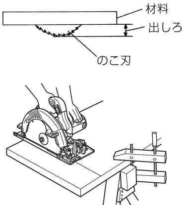
のこ刃は材料の下面より出ますので、材料は作業台の上にのせて切断してください。また、のこ刃および保護カバーが地面に接触しないように十分な高さ(のこ刃の出しろの3倍以上)にしてください。
