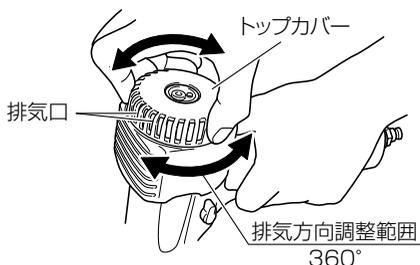
ヘッドリングを回して排気口の向きを360°の範囲で変えることができます。
