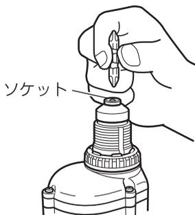
ビットをソケットの穴に合わせて十分に押し込みます。
