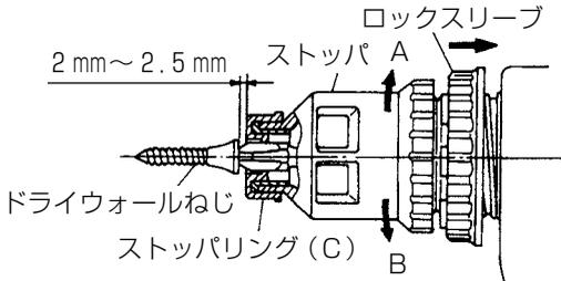
ボード表面の損傷防止のため、ストップリング (C) を使用してください。
