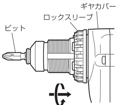
(1) ロックスリーブを十分に引き(→)、左に回して(⊖)ギヤカバーに固定し、ロックスリーブをストップ側へ戻らなくします。
