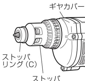
ねじのゆるめ作業の際は、①ストップリング (C) をはずすか、または②ストップを約1回転ギヤカバー側に回してください。
