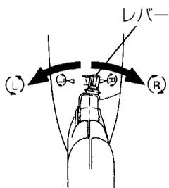
リバーシングスイッチのレバーを「R」側にたおすとビットは後側から見て右へ回ってねじを締め、「L」側にたおすと左へ回ってねじをゆるめます。
