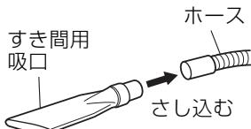
付属品のホースの先端に付属品のすき間用吸口をさし込みます。
