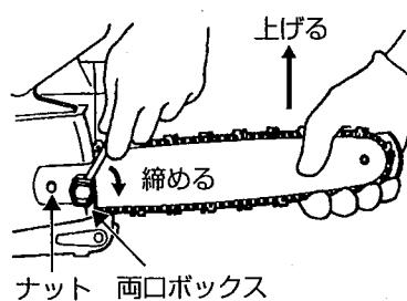
(1) チェンカバー締付け用のナットを軽くゆるめた状態でガイドバーの先端を持ち上げながら、マイナスドライバーでガイドバーのピニオンギヤを回し、チェン刃の張りを調整します。ピニオンギヤを右に回すとチェン刃の張りは強くなります。
