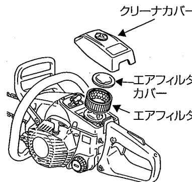
長期間使用しエアクリーナに木くずなどがたまるとエンジン性能の低下の原因になるので、ときどき点検してください。
