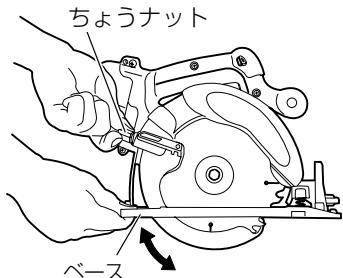
ちょうナット(切込み調整用)をゆるめ、ベースを上下させて調整します。調整が終ったら、ちょうナットを固く締付けてください。
