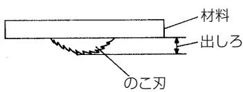
のこ刃は材料の下面より出ますので、材料は作業台の上にのせて切断してください。
