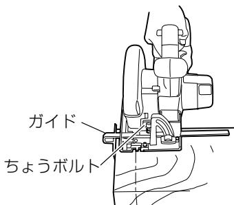
ちょうボルトをゆるめ、ガイドを左右に動かして切断位置を調整します。
