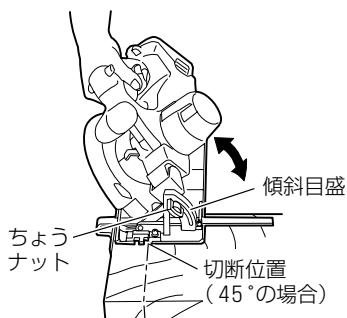
傾斜目盛のところのちょうナットをゆるめると、のこ刃をベースに対して最大 47°まで傾けることができます。
