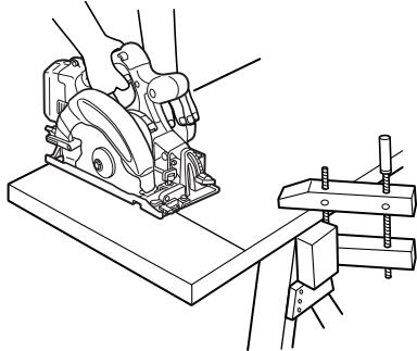
材料の切り落とし側が大きいときは、切断中に材料の重みでのこ刃がはさみつけられないよう、切り落とし側にも安定性のよい台または角材を設けてください。
