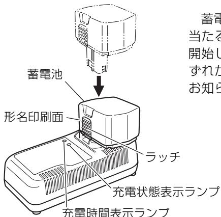
蓄電池を左図に示す向きで、充電器の底に当たるまでしっかりとさし込みますと充電を開始し、充電時間表示ランプが赤/橙/緑のいずれかに連続点灯して充電完了までの時間をお知らせします。
