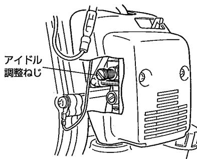
スロットルレバーを低速の位置にしてアイドル調整ねじをしめ込むと低速回転（アイドリング回転）が高くなり、ゆるめると低くなります。スロットルレバーを低速の位置にしても刈刃が回転するときは、刈刃が回転しないようなアイドリング回転に調整してください。
