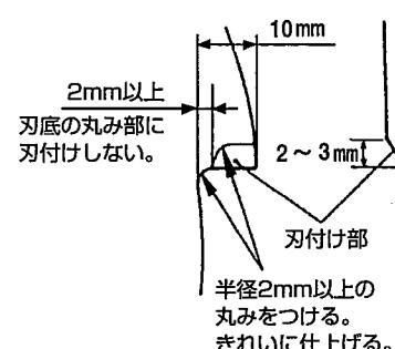
8枚刃（別売部品の16枚刃も同様）をとぐ場合は左図のようにとぎます。8枚刃のケースに記載してある「刃型ゲージ」を利用しますと、刃とぎが容易にできます。
