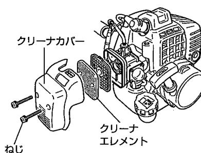
チョークレバー（19ページの下図参照）を閉じてから、ねじをゆるめてクリーナカバーをはずし、クリーナエレメントを取り出しそよごれをブラシで落とすか、中性洗剤で洗ってください。中性洗剤で洗ったときは、十分に水洗いし、よく乾かしてください。
