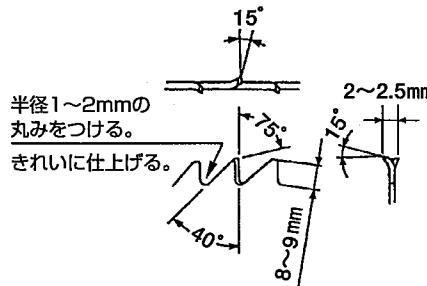
刃の谷に割れが起こらないように、必ず半径1~2mmの丸みをつけてください。
