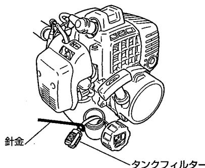
タンクフィルターがつまるとガソリンが上らず、エンジンの回転不調の原因になりますので、ときどき点検してください。
