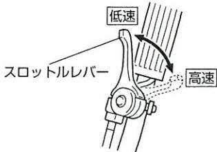
スロットルレバーを**「低速」**の位置に戻して、しばらく運転します。次にストップスイッチを**「停止」**の位置にします。
