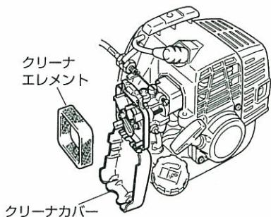
チョークレバー（19ページの中図参照）を閉じてからクリーナカバーをはずし、クリーナエレメントを取り出し、よごれをブラシで落とすか、中性洗剤で洗ってください。中性洗剤で洗ったときは、十分に水洗いし、よく乾かしてください。
