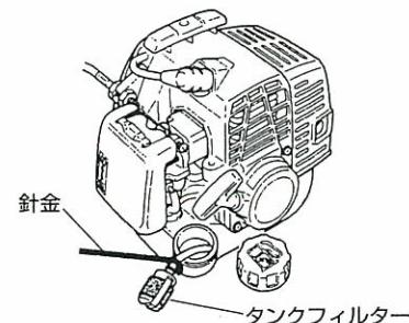
タンクフィルターがつまるとガソリンが上らず、エンジンの回転不調の原因になりますので、ときどき点検してください。
