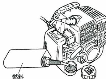
始動前のエンジンが冷えた状態で、燃料 [ガソリン25：オイル (2サイクル専用オイル) 1] を燃料タンクに入れます。
