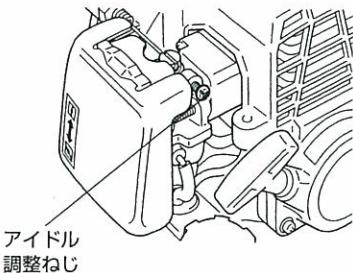
スロットルレバーを低速の位置にしてアイドル調整ねじをしめ込むと低速回転（アイドリング回転）が高くなり、ゆるめると低くなります。スロットルレバーを低速の位置にしても刈刃が回転するときは、刈刃が回転しないようなアイドリング回転に調整してください。
