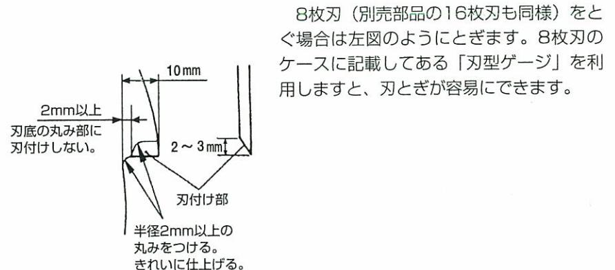
8枚刃（別売部品の16枚刃も同様）をとぐ場合は左図のようにとぎます。8枚刃のケースに記載してある「刃型ゲージ」を利用しますと、刃とぎが容易にできます。
