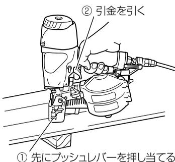
単発打ちは、仕上げを重視する場合や狙った所に釘を打つ場合に使用します。打ち込む所にプッシュレバーを押し当て、引金を引く動作で、釘を一本ずつ打つことができます。
