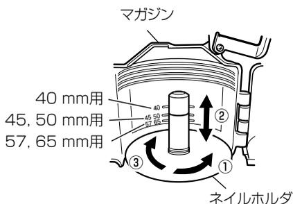
調整は、①ネイルホルダを約90°左に回します。②ネイルホルダを上下に動かし、使用する釘の長さに合わせてマガジンの目印の位置にネイルホルダの上面を合わせます。
