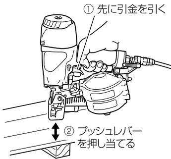
連続打ちは、はじめに引金を引いておき、その後、釘を打つ所にプッシュレバーを「トン・トン・トン」と押し当てれば、連続的に作業ができます。
