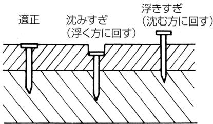
**注** • 打ち込み深さは、使用空気圧力によっても調整できるのでアジャスタの調整と併用してください。
