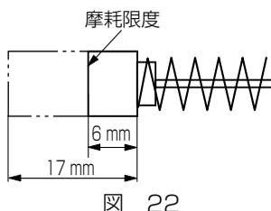
モーター部には、消耗品であるカーボンブラシを使用しております。カーボンブラシの摩耗が大きくなりますと、モーターの故障の原因となりますので、長さが摩耗限度(6 mm ぐらい)になりましたら新品と交換してください。
