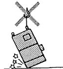
吊りボルトは必ず2本共使用し、移動は静かに。本体破損の原因になります。
