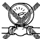
指定以外の圧力を使用しますと、エアタンク破損や電磁弁故障の原因になります。
