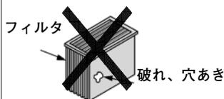
フィルタが破れていたり、穴のあいたまま使用しますと、ファン破損の原因になります。
