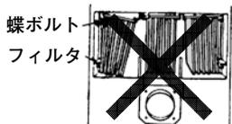
フィルタが外れたまま使用しますとファン破損の原因になります。
