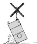
吊りボルトは必ず4本共使用し、クレーンやフォークリフトで吊り上げて静かに移動させてください。
