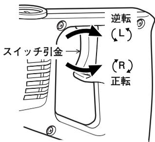
スイッチは図4のようにスイッチ引金の (R) 側を引くことにより正転、(L) 側を引くことにより逆転となり、スイッチ引金の引く位置により回転方向の切替えができます。
