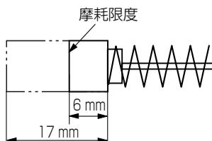
モーター部には、消耗品であるカーボンブラシを使用しております。カーボンブラシの摩耗が大きくなりますと、モーターの故障の原因となりますので、長さが摩耗限度 (6 mm ぐらい) になりましたら新品と交換してください。
