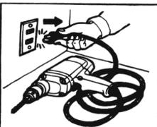
使用後は必ずスイッチを切りさし込みプラグを電源から抜いてください。
