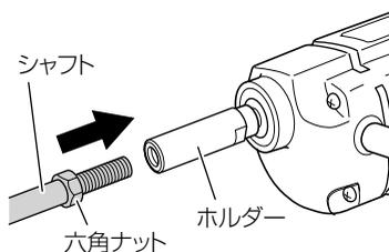
次に、ホルダーの切欠部をスパナ（幅 17 mm）で押さえながら、別の両口スパナ（幅 19 mm 側）で六角ナットを矢印の方向に締付けてください。
