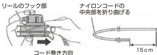
**5** 巻き終えたナイロンコードの先端を18cm程度残し、向かい合う位置にあるリールの切込みにそれぞれコードを挟み込み、仮止めしてください。
