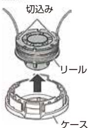
**4** ナイロンコードの両端を15cmくらいずらして、中央部を折り曲げ、リールのフック部に引っ掛けてリールの矢印方向に交差しないように巻いてください。
