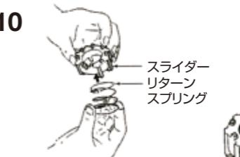
リターンスプリングの引掛部をスライダの切欠き溝に内側から入れながら、左図のようにしてセットします。
