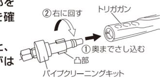
4. パイプクリーニングキットの取付け部を、洗浄するパイプの中にさし込みます。
